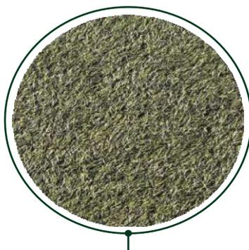
Avant le passage du Joker, les fibres sont couchées, le granulat est compacté.
