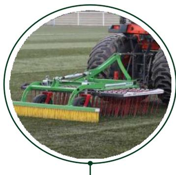
Décompactage/brossage réalisé à grande vitesse : 30-45 min pour 8 000 m<sup>2</sup> entre 8 et 12 km/h.
